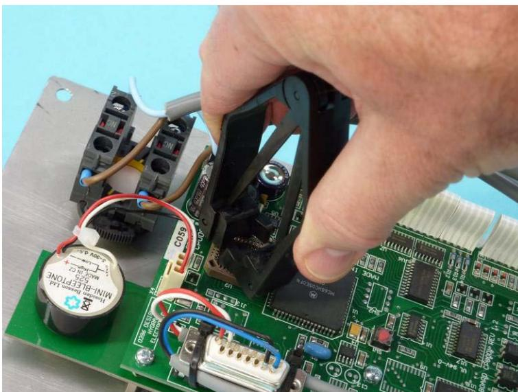
*Squeeze the two sides of the IC Remover till the IC pops out.*
